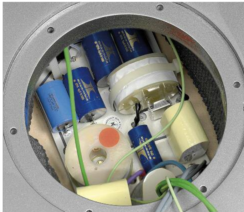
Und hier Teil 2 für den Hochtonbereich. Wenige Hersteller machen sich die Mühe, die Weichenbauteile so gut zu isolieren und vor Rückströmen zu schützen
