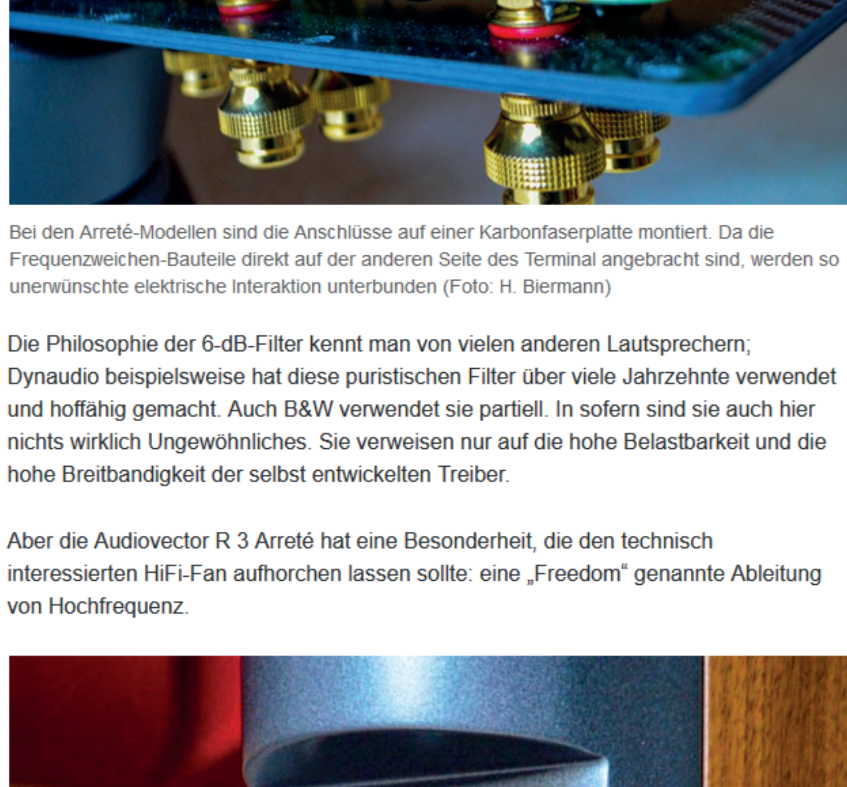
Bei den Arrêté-Modellen sind die Anschlüsse auf einer Kohlenfaserplatte montiert. Da die Frequenzweichen-Bauteile direkt auf der anderen Seite des Terminal angebracht sind, werden so unerwünschte elektrische Interaktion unterbunden (Foto: H. Biermann)
