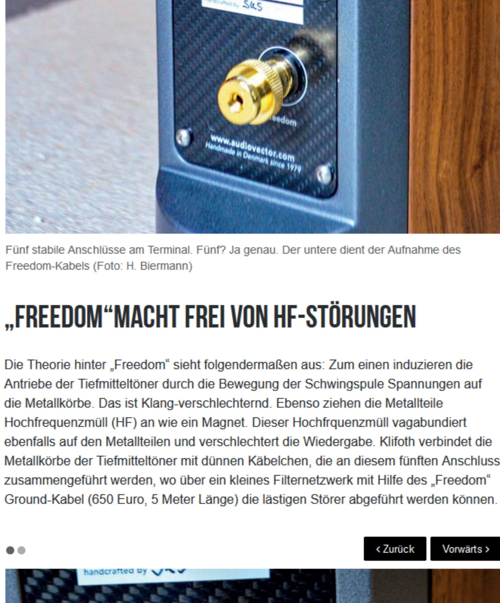
Fünf stabile Anschlüsse am Terminal. Fünf? Ja genau. Der untere dient der Aufnahme des Freedom-Kabels (Foto: H. Biermann)
