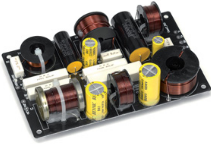
Weichenbau ist bei Gamut keine spartanische Angelegenheit. Das Arrangement bester Bauteile vermeidet Phasendrehungen der Treiber fast vollständig
