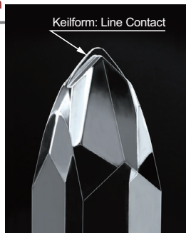
● 2000fach vergrößerte Ansicht der Abtastnadel
